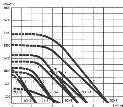
\*) serienmässig angebauter Motor mit 1,1 kW reicht nur für den gezeichneten Kennlinienbereich. Wenn der Betriebspunkt über 1000 mm WS liegt, sollte das Gebläse verwendet werden.
