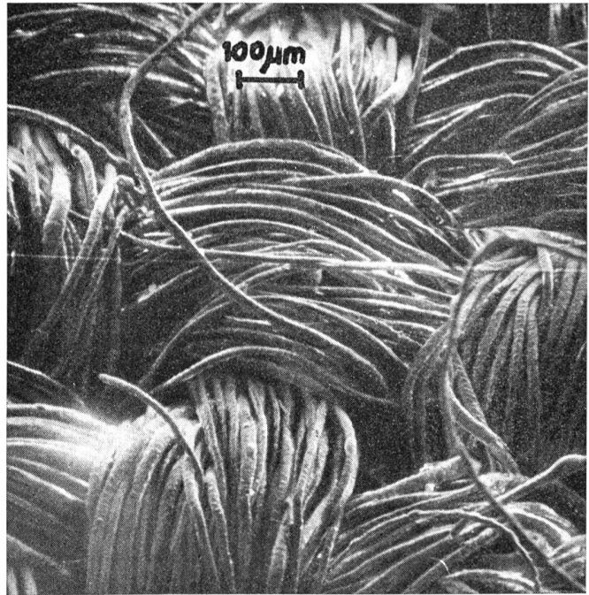
Abb. 13 Wollgewebe mit Filzfreieusrüstung (Sekundärelektronen-Bild)
