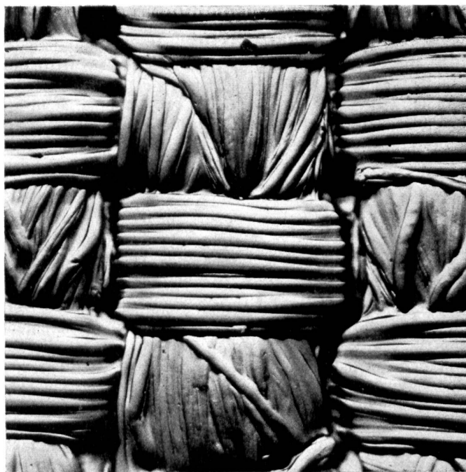
Gewebe aus Polyamid-Stapelfasern, dessen Oberfläche in Gelatine abgedrückt wurde (100:1) .— Nichtgeschädigte Stellen.
