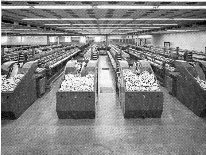
Mit dieser vollautomatischen Spulstrasse lieferte Schlafhorst die 500 000. Spindel des Kreuzspulautomaten AUTOCONER an die Textilindustrie. In dieser menschenleeren Anlage, sie steht bei der Firma Lauffenmühle, Tiengen, hat der Mensch nur noch überwachende Aufgaben.
