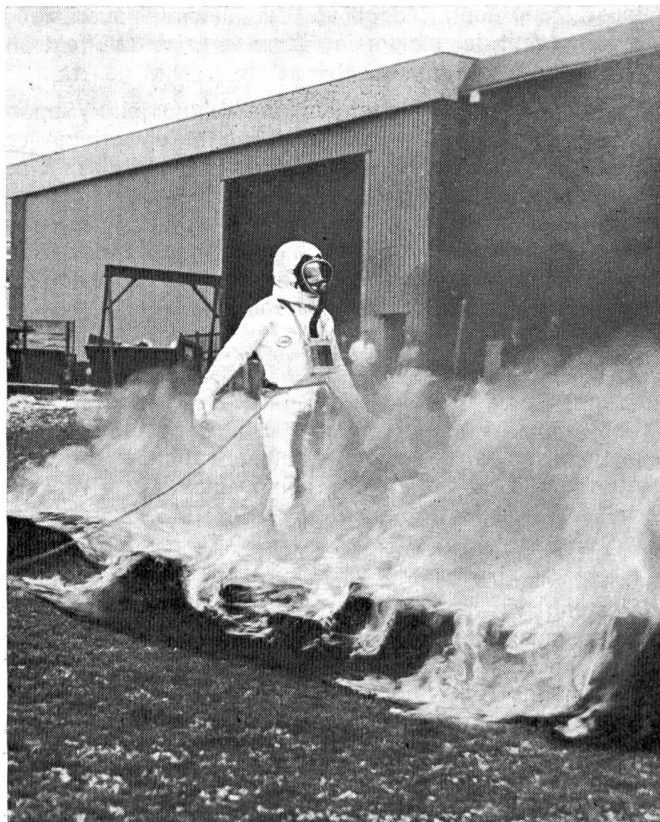
Abbildung 2 Bei der Schutzkleidung für Rennfahrer (Automobil- und Motorradsport) kommt es vor allem auf Schutz gegen intensive Hitzeeinwirkung während kurzer Perioden an. Hier bewährt sich Kleidung, die aus einer oder zwei Lagen flammfester reinwollener Unterwäsche und einem ebenfalls mit IWS-Flammfestausrüstung versehenen Overall aus etwa 85 % Wolle und 15 % Glasfaser besteht. Sie wurde von der Jim Clark Foundation für Grand-Prix- und andere Rennen empfohlen (BFF).
