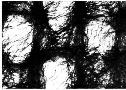
Bild 6: Wasserstrahlverfestigtes Vlies nach dem «Spunlaced»-Verfahren
