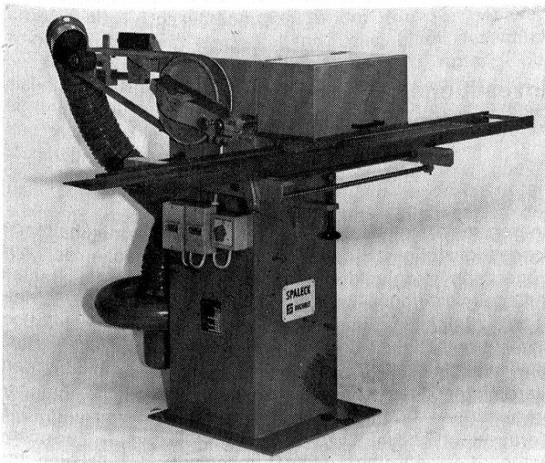
Abbildung 3 Webeblattbürstmaschine mit Zusatzgerät zum Abrichten von Webschützen
