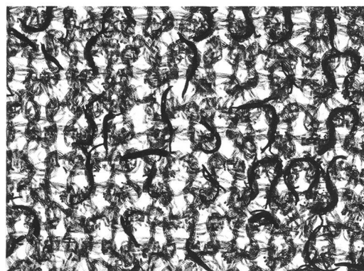
Abb. 3 Asymmetrie in einem Gewirk: ein Maschinenstillstand bewirkte die Störung im Maschenbild. Die Maschenreihe hob sich scheinbar heller gefärbt und glänzend von der Umgebung ab (Durchlicht, 20:1).
