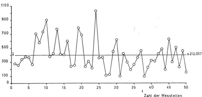
Abbildung 6 Falzzahl längs über die Breite von 220 cm
