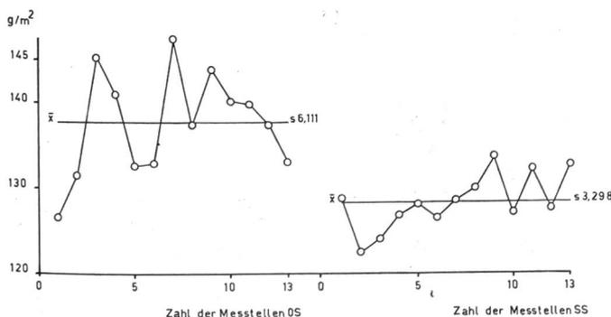
Abbildung 10 Cobb-Test über die Breite von 220 cm
