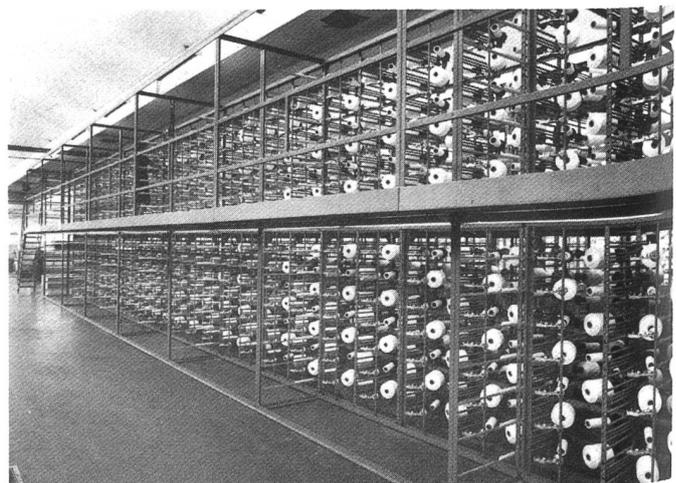
Mit dieser Hilfseinrichtung steckt eine Bedienungsperson die bis 20 kg schweren Kreuzspulen mühelos auf.
