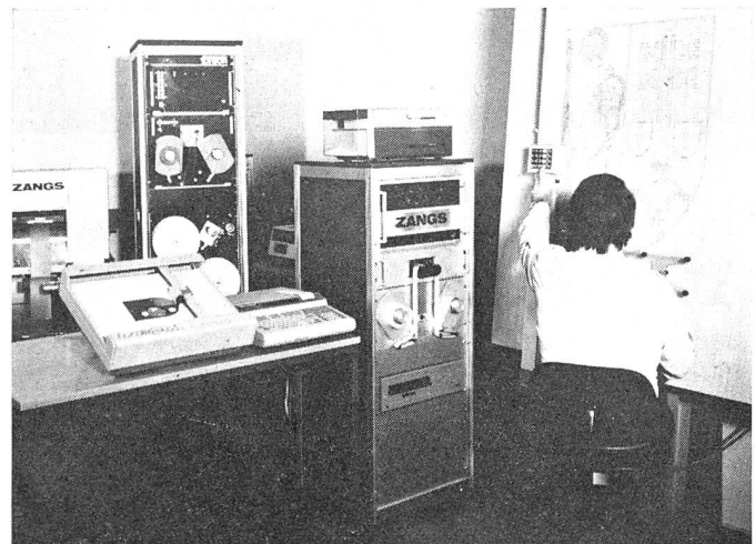
Zangs-Punchtronic-System® 195, computergesteuerte Stick-Atelieranlage zur Herstellung von Steuerkarten für Mehrkopf-Stickautomaten und Schiffchen-Stickmaschinen.
