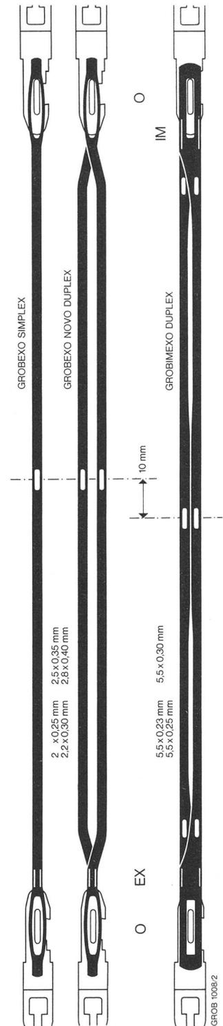
stahl hergestellt. Im Endösenbereich sind sie widerstandsfähiger, da die volle Bandbreite erhalten bleibt, wodurch ein Prägen des Stahlbandes zur Ausweitung der Endösen nicht erforderlich ist. «GROBIMEXO»-Flachstahl-Weblitzen können mit der Einziehmaschine «USTER» für Flachstahl-Weblitzen mit O-förmigen Endösen und der «BARBER-COLMAN»-Einziehmaschine, die mit der entsprechenden Zusatzeinrichtung ausgerüstet ist, automatisch eingezogen werden.
