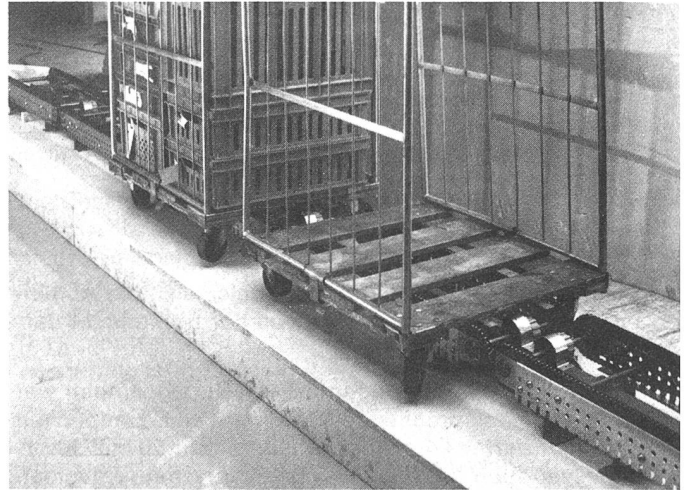
Stockroll-Typenreihe SK. Im Sondereinsatz für den Cadi-Transport. Überhängende Räder bilden keinerlei Erschwernisse.
