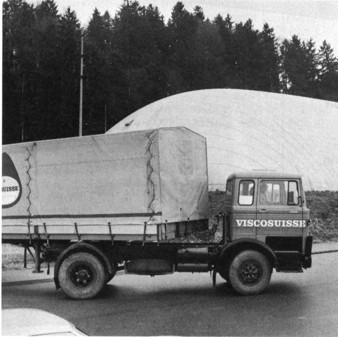
Anwendungsgebiet der hochfesten Nylsuisse- und Tersuisse-Garne: Beschichtungs- und Gummierungsgewebe, für Lastwagenplanen, Traglufthallen und ähnliches.
