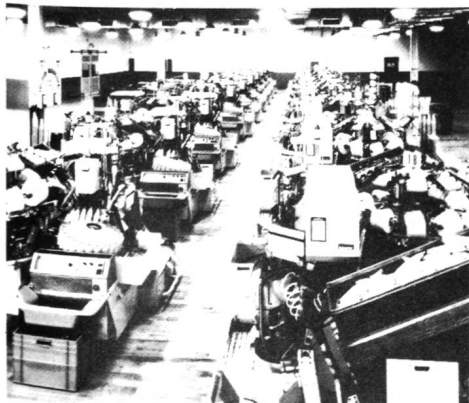
«Vollautomaten»- Anlage mit 260 Spindeln Schweiter-Coner CA 12-DV
