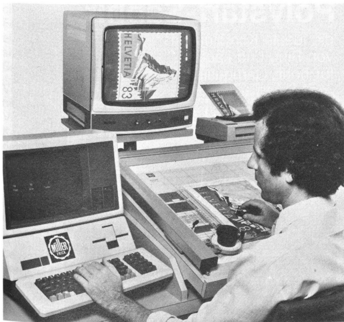
Programmieranlage System MÜCOMP II für elektronische Jacquard-Maschine EPD
