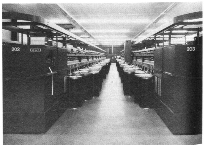
Die mit 220 Spinnstellen arbeitende OE-Rotorspinnmaschine verfügt über kompakte Spinnboxen mit optimaler Spinngeometrie für die Verarbeitung aller Fasern bis 600 mm.
