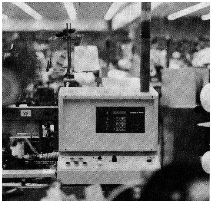
Herzstück der Webmaschinenüberwachung und -steuerung: der Mikroprozessor
