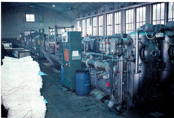
Die Veredlung umfasst HT-Jet und Breitfärbemaschinen sowie Haspelkufen und Sternfärbeapparate. Sie ist eingerichtet für ein Produkionsortiment von Geweben in verschiedensten Gewichtsklassen, Materialzusammensetzungen und Konstruktionen.
