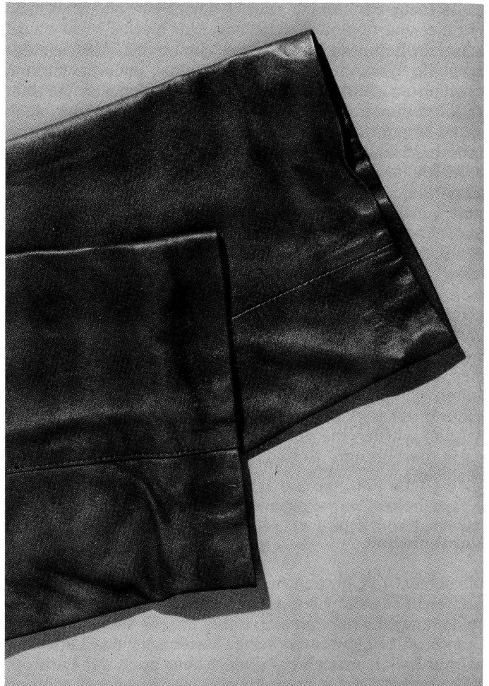
Abb. 3: Fleckenbildung durch nicht reinigungsbeständigen Klebstoff nach der Trockenreinigung.
