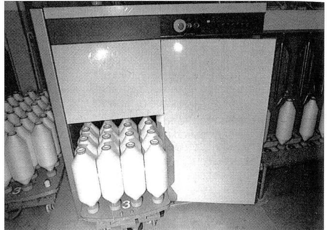
Die Spulen werden ab den Toyoda-Flyern in der Ringspinnerei der Textilgruppe Hof automatisch zu handlichen Paketen abgeführt und palettiert.
