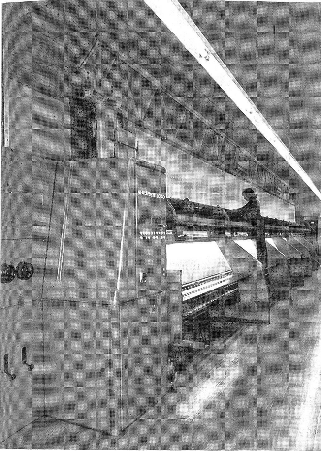
5 Maschinen des Typs Saurer 1040 mit 15 Yards Sticklänge werden in Kürze Stickereien in «Saurer-Qualität» produzieren.
