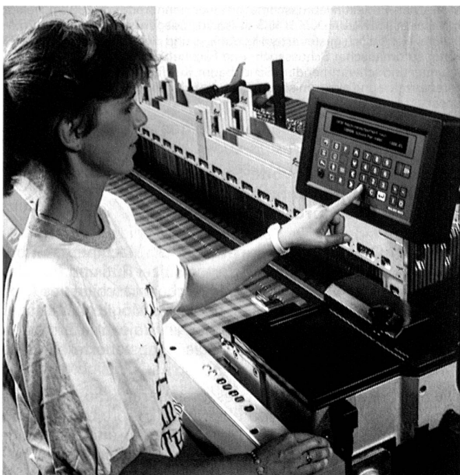
P 7100 W 190 N 4 SP D1 M Zentrale Mikroprozessorsteuerung an einer Vierfarben-Projektwebmaschine
