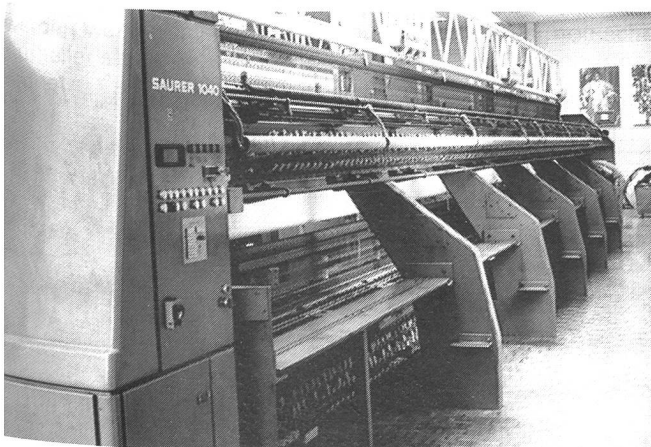
An den Saurer-1040-Einheiten wird das Maschinenterminal in den Schaltschrank integriert.
