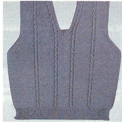
Abb. 9: Formgebung über Fully-Fashioned-Technik (MC-745)
