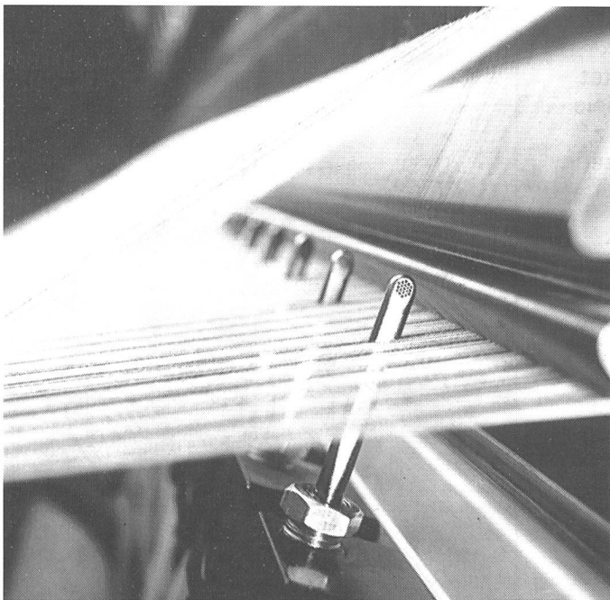
Abb. 1: Luftdüsenwebmaschine. Blick ins Webfach
