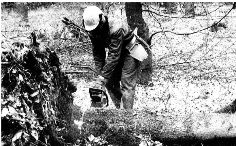
Textilien schützen Waldarbeiter vor schweren Verletzungen. Erreicht wird das mit einem Kniff. Die Arbeitsanzüge werden mit einer Schnittschutzeinlage ausgestattet, die aus mehreren Schichten langer Fäden besteht.
