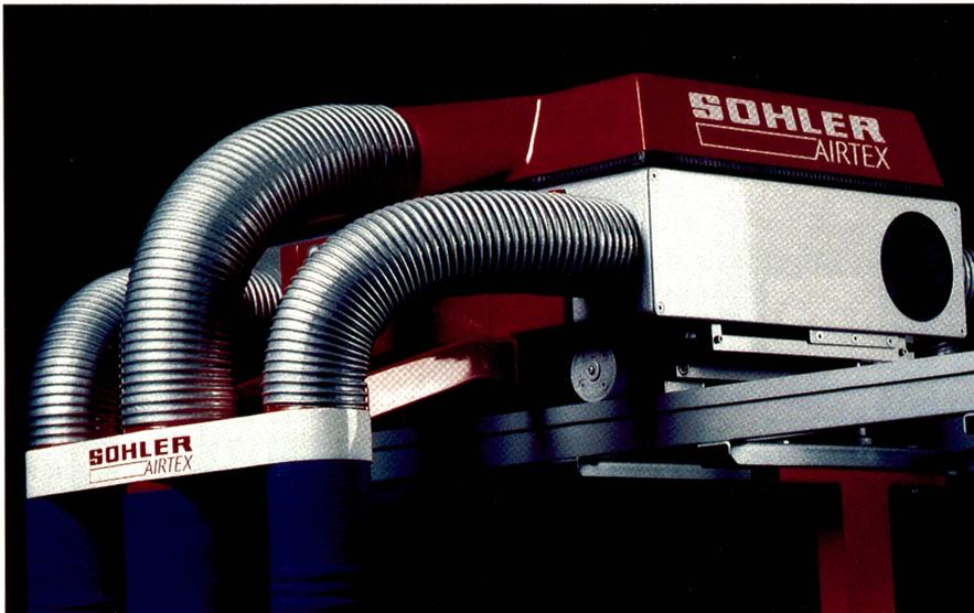
Das Gerät kann im Baukastenprinzip wahlweise mit Lüftermotoren von 1,5 bis 3,0 kW ausgerüstet werden. Es entleert am Maschinenende vollautomatisch in eine zentrale Abfallentsorgung. Die Energiezufuhr erfolgt entweder über Stromschienen oder alternativ über Energiekette.
