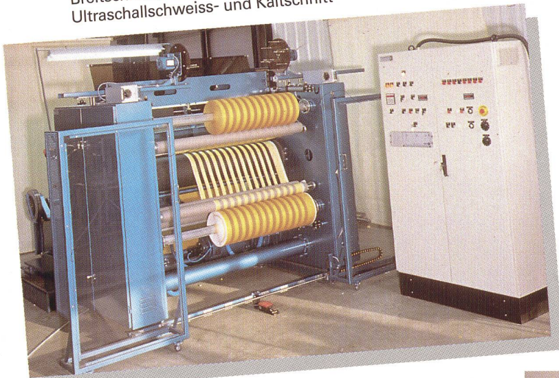
Kaltschneidmaschine Type GTE - Aufwickelseite
