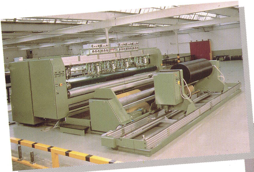
Breitschneidmaschine für kombinierten Ultraschallschweiss- und Kaltschnitt
