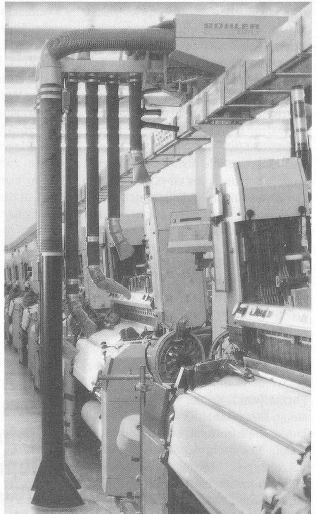
Wanderreiniger haben auf allen Typen moderner Webmaschinen, ob Projektil-, Luft- oder Greiferwebmaschinen, Eingang gefunden. Durch die Erfolge hinsichtlich ihres Effektes und durch die inzwischen erlangte konstruktive Reife haben sie sich in der modernen Weberei behauptet und einen festen Platz als wichtiges Zubehörgerät errungen. Bild: Sohler Airtex
