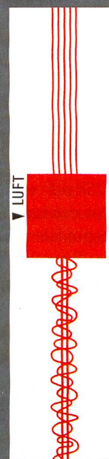
Texturierzüsen HemaJet® für luftblastextu- rierte Garne.
