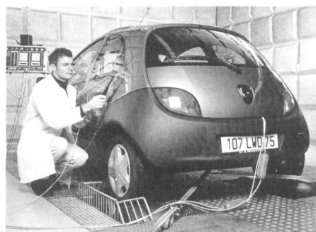
Akustische und schwingungstechnische Untersuchungen bei Rieter Automotive Systems
