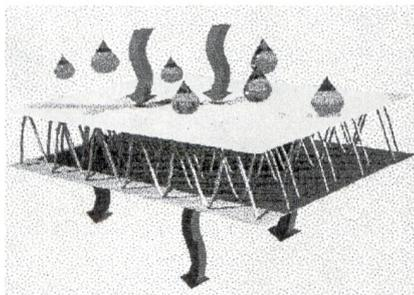
Dem monofilen, nicht feuchteleitenden Fadensystem wurde ein zweites, polyfiles Fadensystem zum Zweck des Feuchtetransportes hinzugefügt. Dabei spielt die Beschaffenheit dieses Fadenmaterials hinsichtlich Kapillanzahl, Fadenprofil und Feuchteleitvermögen eine grosse
