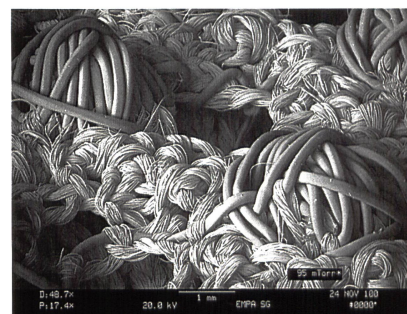
Strukturierte Oberfläche eines Wundpads (Rasterelektronenmikroskopische Aufnahme)
