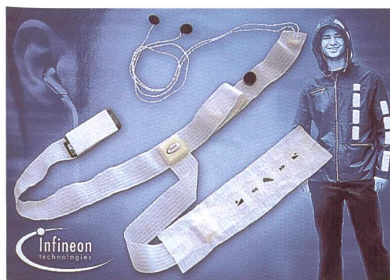
Abb. 3: Flexible Verbindung der Komponenten
