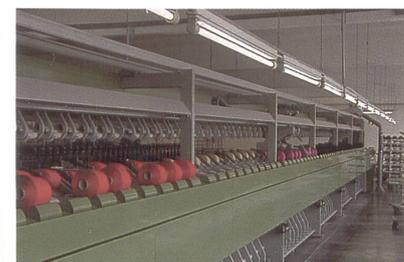
Abb. 12: Die Spulmaschine Autoconer 338 (Foto Schlafhorst)
