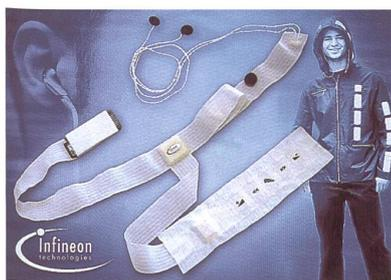
Abb. 3: Flexible Verbindung der Komponenten
