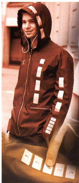
Infineon-Anorak mit Textildraht (Datenübertragung)
