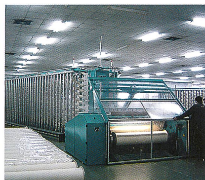
Abb. 3. Färbebaumzettelmaschine mit der neuen Wickeldichtenregelung
