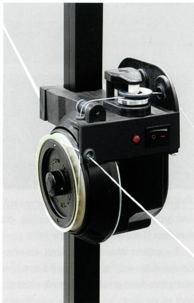
Abb. 2: Die rechnergesteuerte Fadenbremse AccuTense
