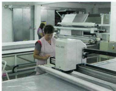
Abb. 2: automatischer Cutter
