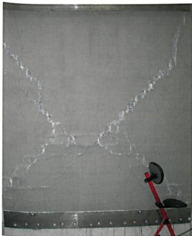
Mauersegment nach dem Erdbeben-Test
