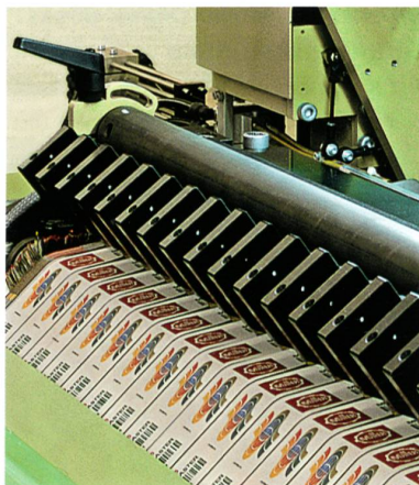
Abb. 10: Schneideelemente TVT2 für die Herstellung haufreundlicher Etikettenkanten
