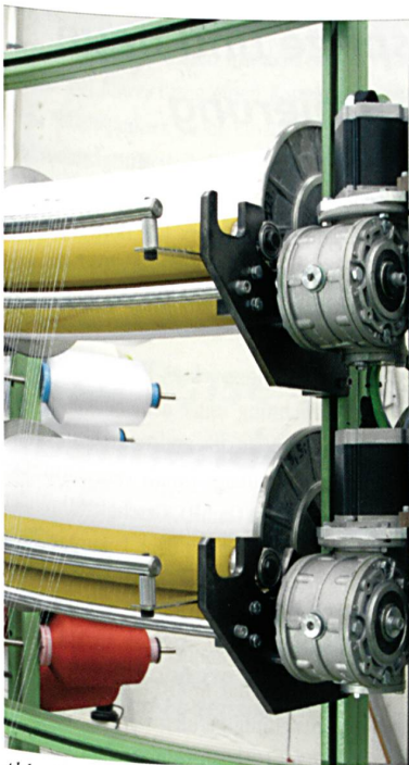
Abb. 6: Geregelte Zuführung von Kant- und Ripsfäden
