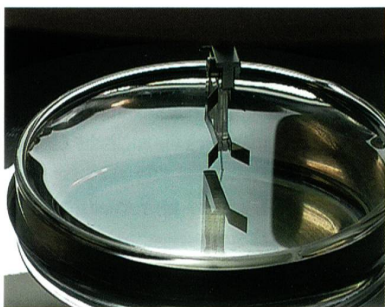
Vollautomatische Reihen-Benetzungsmessung von Einzelfasern
