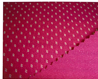
Abb. 2: Spacerknit mit Checkmuster und hydrophobem Finish
