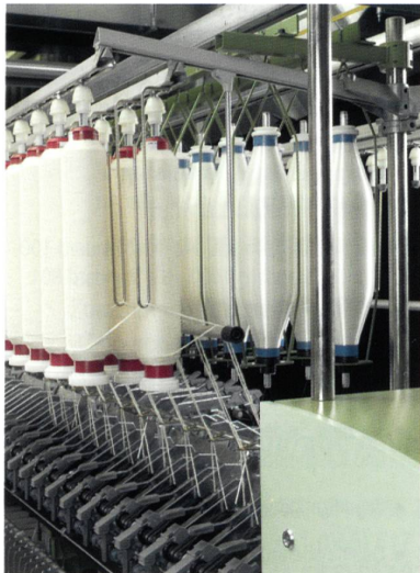
Abb. 1: System auf ComforSpin-Maschine K 44 zur Herstellung von unelastischen Coregarnen
