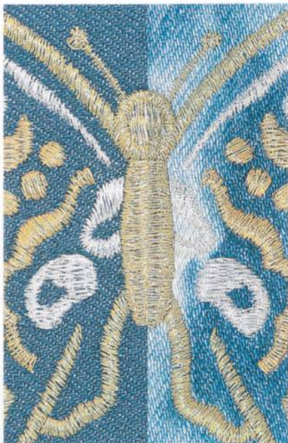
Abb. 1: Das chlorechte Metallgarn vor und nach der Denim-Wäsche!
