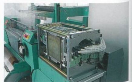
Abb. 2: Linearmotoren zur Steuerung der Legebarren
