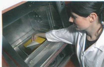
Abb. 2: Mit dem Hautmodell können durch die Simulation der Wärme- und Schweißabgabe der menschlichen Haut verschiedene bekleidungsphysiologische Kennzahlen für ein Textil ermittelt werden
