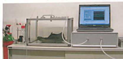
Abb. 2: Mit Hilfe der so genannten «Elektronischen Nase» soll künftig bereits bei der Entwicklung von Schuhen und Strümpfen das Potential für unangenehmen Schweissgeruch abschätzbar sein, Bild: PFI Pirmasens
