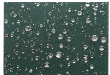
Abb. 2: Hochschmutzabweisende Fasern sind dank neuer Faserstrukturierung nun auch resistent gegen äusserliche Einflüsse wie Waschen oder Kratzen
