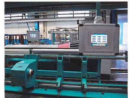
Abb. 1: Anordnung der Operator Interfaces an der Nov-O-Matic 2
