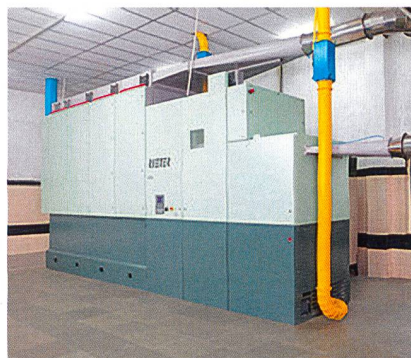
Abb. 4: Kein anderes System erreicht auf kleinstem Raum eine so intensive und homogene Durchmischung wie die Mischmaschine UNImix B 72 / B 76
